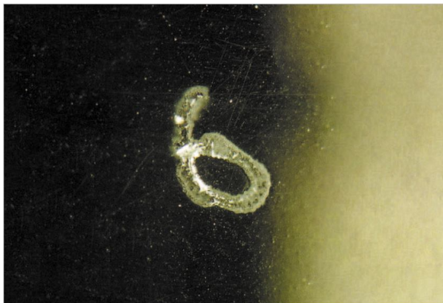
Рис. 2.65 Под лупой: повреждение от мушки
