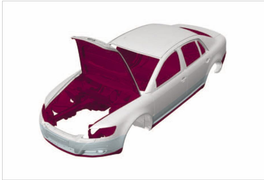
Рис. 3.1 Окрашенные поверхности, скрытые под облицовкой, относят к зоне 3
