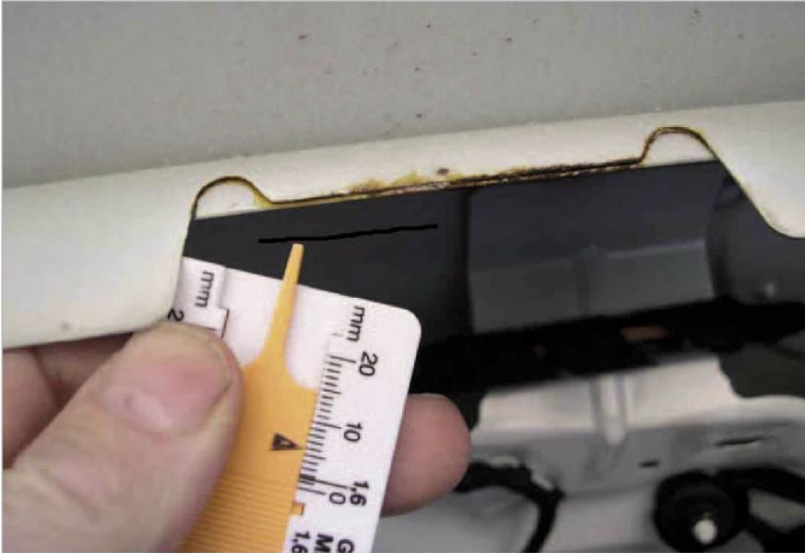
Рис. 2.20 Соединение стальных листов с внутренней стороны
