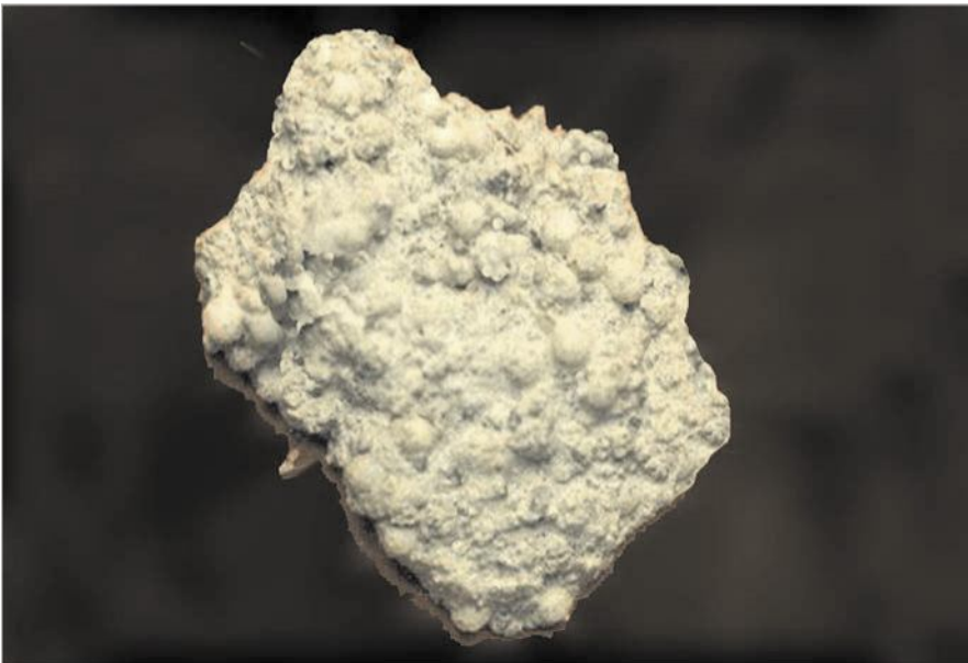
Рис. 2.89 Под лупой: диффундировавшая крошка извести/цемента
