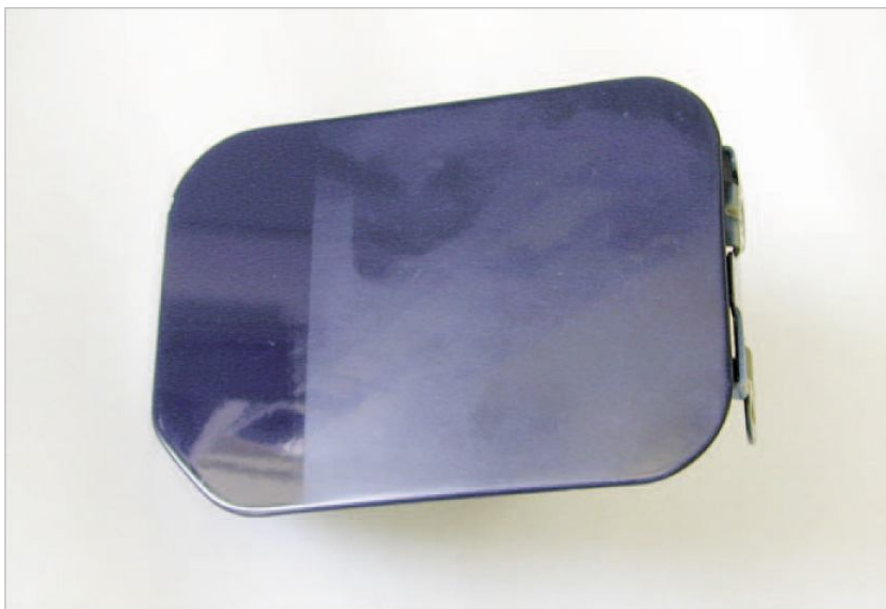
Рис. 2.52 Частично очищенный (слева) лючок топливного бака
