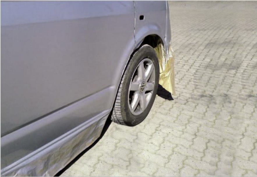
Рис. 2.104 Пятна от точечной подкраски в области колёсной арки
