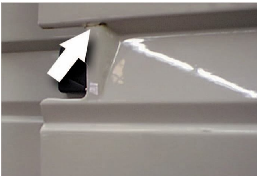
Рис. 2.117 Растрескивание на сдвижной двери
