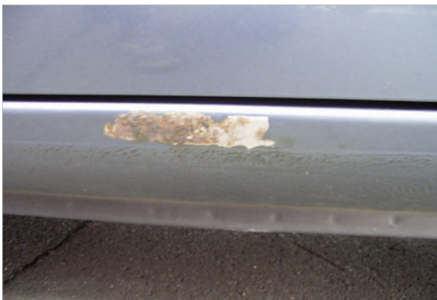
Рис. 2.2 Повреждённый порог под дверью
