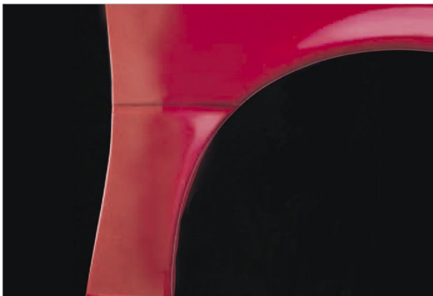
Рис. 2.57 Опыл из-за плохой маскировки
