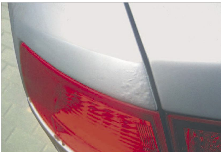
Рис. 2.13 Подплёночная коррозия боковины
