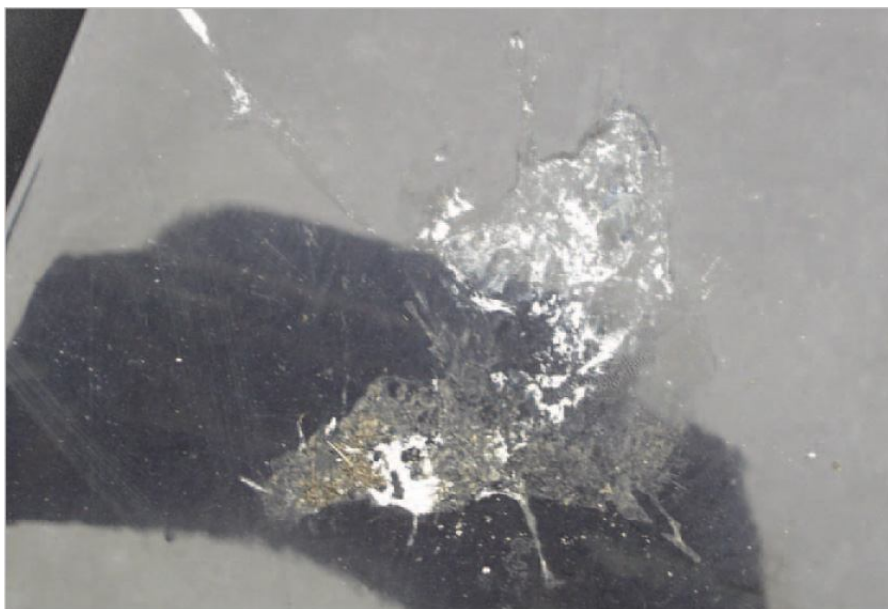
Рис. 2.59 Свежий птичий помёт на покровной эмали
