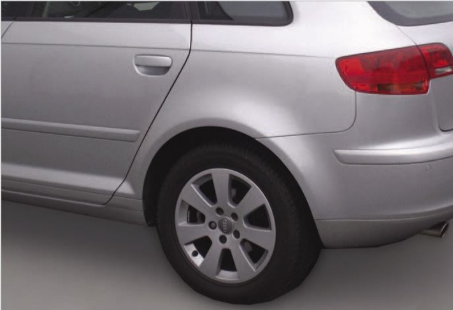
Рис. 2.107 Цвет боковины и бампера не совпадает по тону
