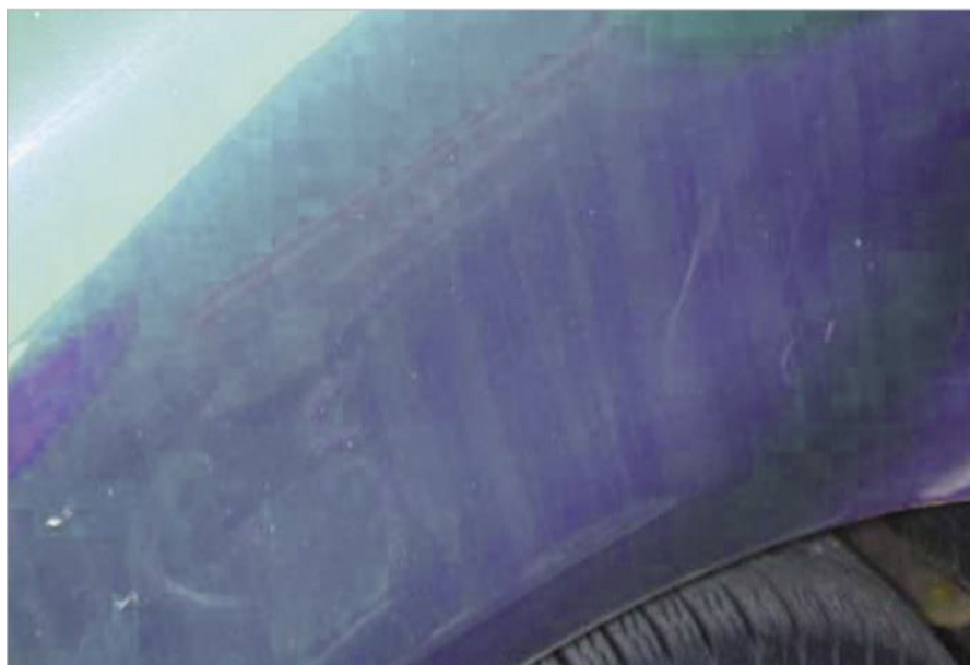
Рис. 2.83 Потёки после кислотного дождя
