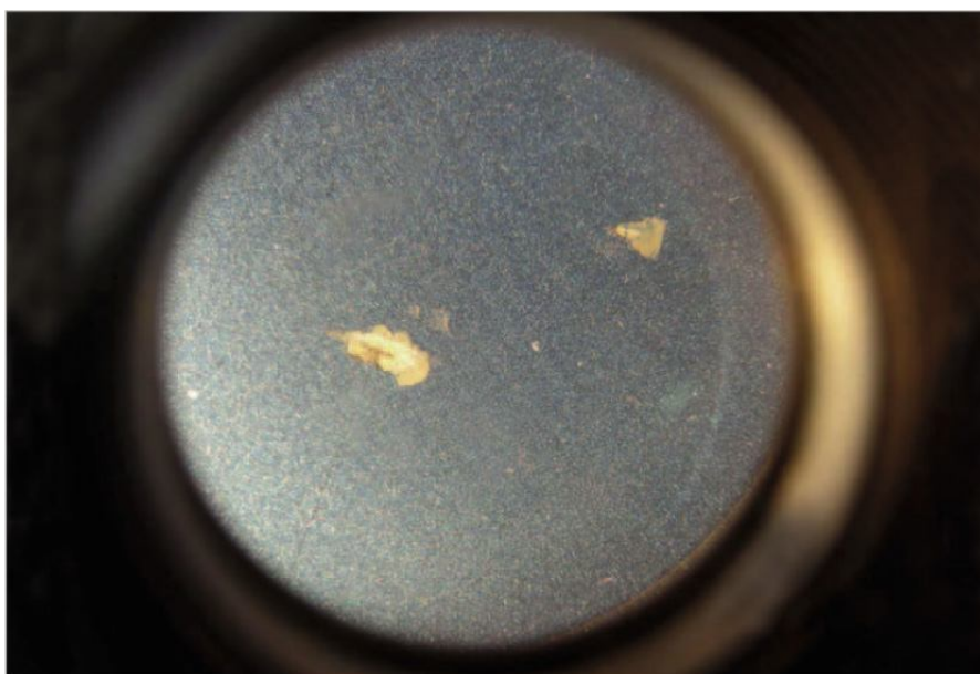
Рис. 2.37 Вид под лупой: отслаивание от удара камнем
