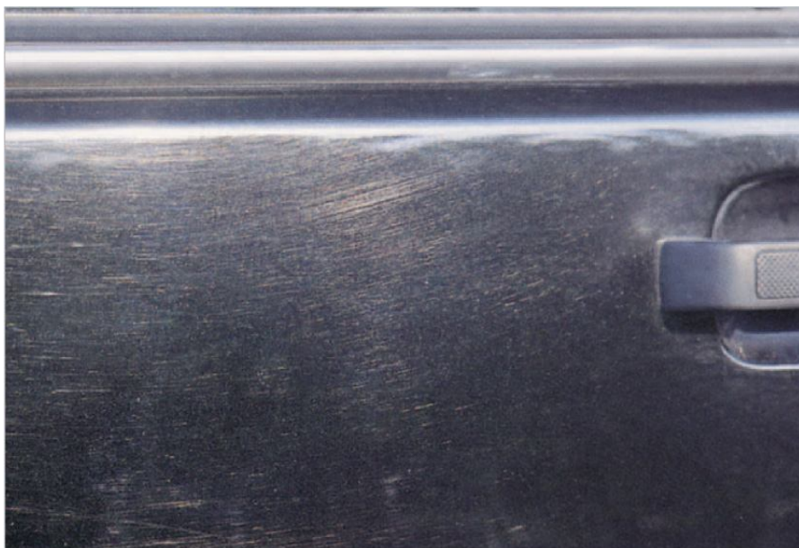
Рис. 2.51 Повреждение наружных слоёв ЛКП щётками автоматической мойки
