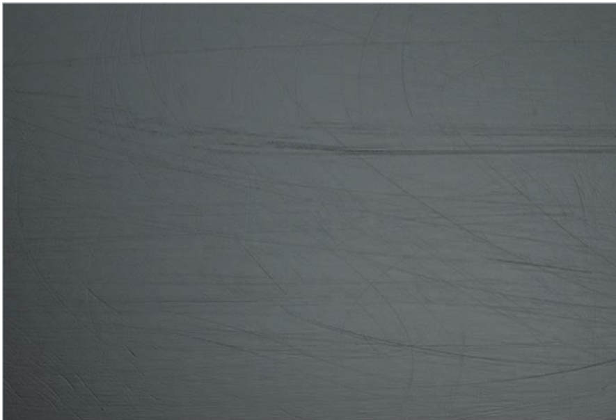
Рис. 2.142 Отчётливо видимые следы шлифовки на окрашенной поверхности
