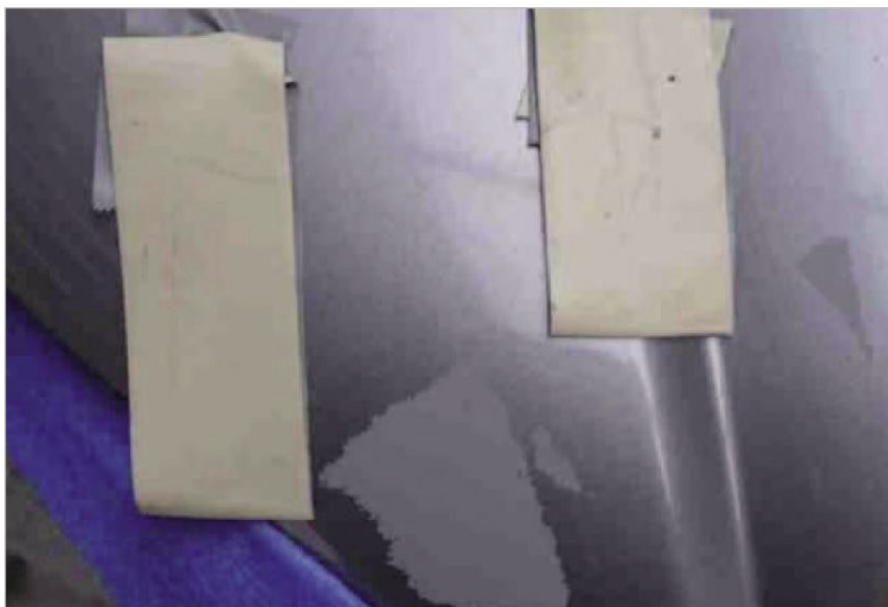
Рис. 2.42 Расчищенное пятно с рваными краями на окрашенном бампере
