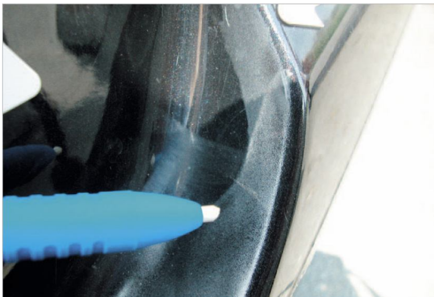
Рис. 2.58 Опыл из-за плохой маскировки
