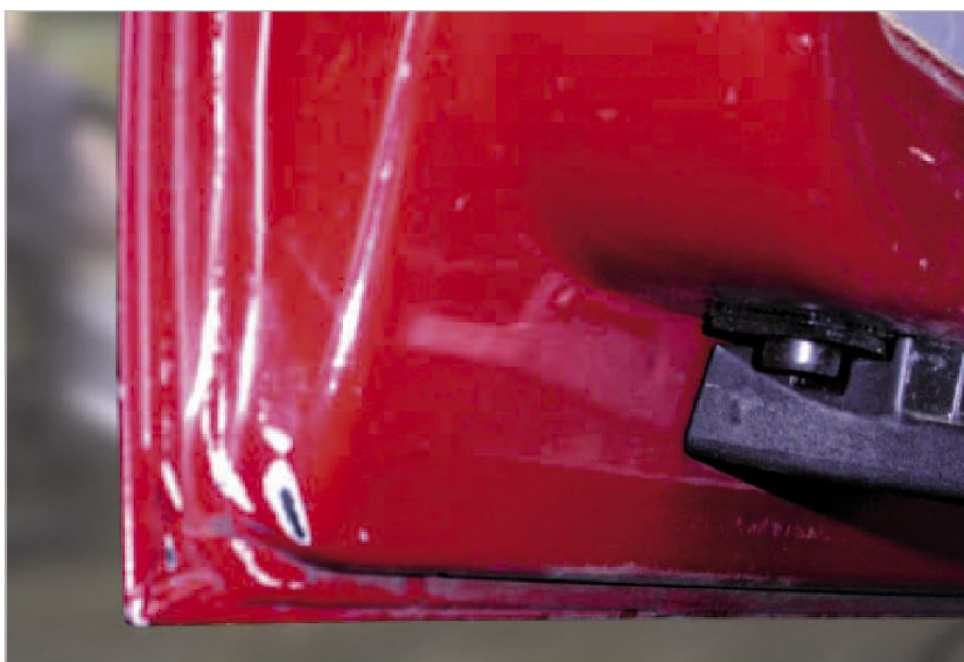
Рис. 2.33 Протёртые наружные слои ЛКП
