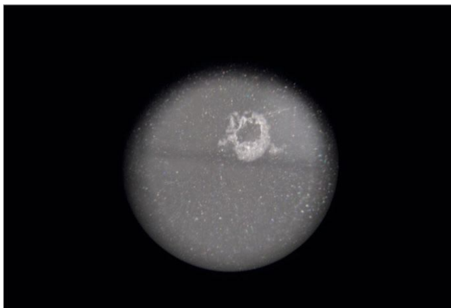
Рис. 2.72 Под лупой: повреждённое древесной смолой ЛКП
