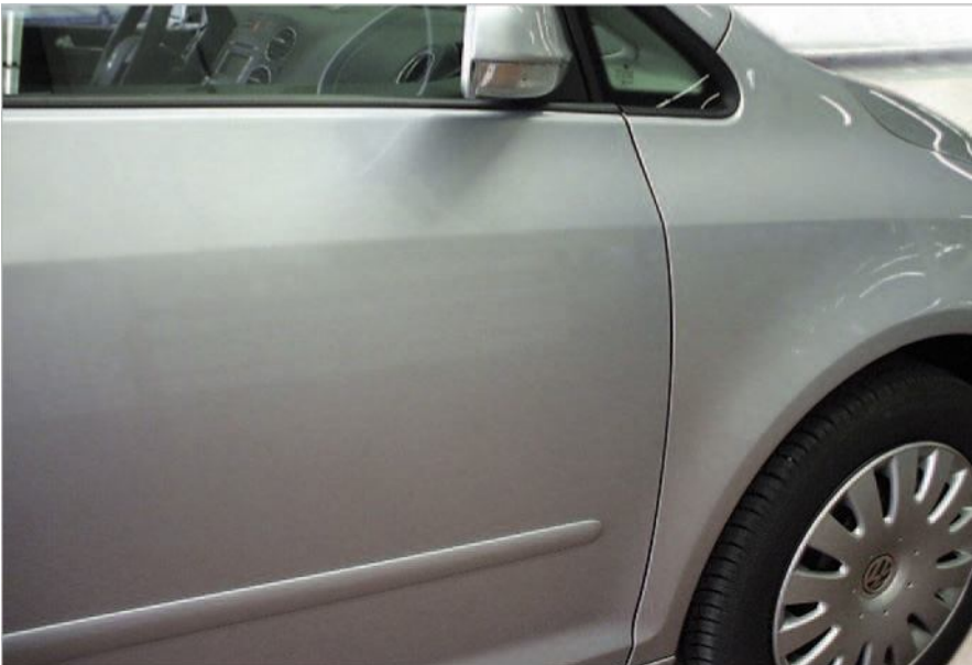
Рис. 2.108 Цвет двери и крыла не совпадает по тону
